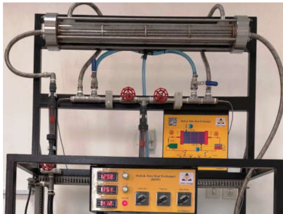
شکل ۱: دستگاه آزمایش مبدل پوسته و لوله
