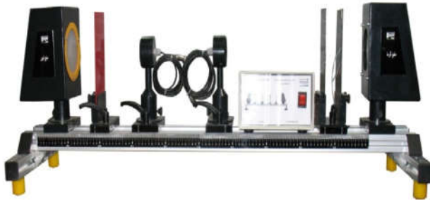
شکل ۱: دستگاه اندازه گیری تشعشع حرارتی
